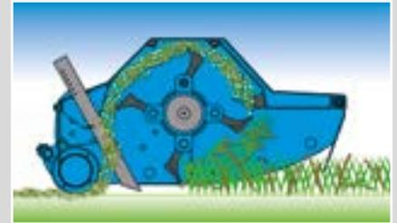
Posizione arretrata del rullo con raschifango e denti di raccolta
